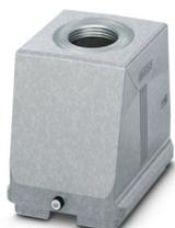
Custodia protettiva B48, per bloccaggio longitudinale, materiale: Pressofuso di alluminio, impermeabile, uscite cavi: 1, diritto, 1x Pg42, altezza: 107,5 mm, connessione a vite per cavo: senza, Standard
