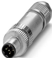
Connettore dati, PROFIBUS DP (12 MBit/s), 2-poli, schermata, Maschio diritto M12, codifica: B, Connessione a molla Push-Lock, materiale zigrinato: Pressogetto di zinco, nichelato, diametro esterno conduttore 4 mm ... 8 mm
