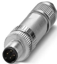
Connettore, Universale, 4-poli, schermata, Maschio diritto M12, codifica: A, Connessione a molla Push-Lock, materiale zigrinato: Pressogetto di zinco, nichelato, diametro esterno conduttore 4 mm ... 8 mm
