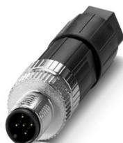
Connettore, Universale, 5-poli, non schermata, Maschio diritto M12, codifica: A, Connessione a molla Push-Lock, materiale zigrinato: Pressogetto di zinco, nichelato, diametro esterno conduttore 4 mm ... 8 mm
