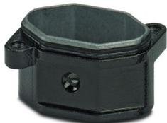
Custodia da incasso D7, per bloccaggio a vite, materiale: Zinco pressofuso, altezza: 24,3 mm, connessione a vite per cavo: senza, coperchio di protezione: no, Applicazioni ferroviarie, per requisiti ambientali ed EMC elevati, Serie HPR
