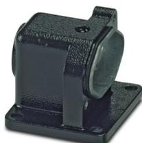
Custodia da incasso D7, per bloccaggio a vite, materiale: Zinco pressofuso, altezza: 41,5 mm, connessione a vite per cavo: senza, coperchio di protezione: no, Applicazioni ferroviarie, per requisiti ambientali ed EMC elevati, Serie HPR, base aperta
