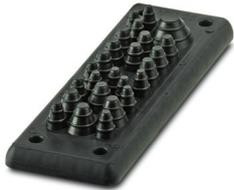
Piastre di ingresso, numero dei conduttori: 25, diametro esterno conduttore: 3x 3 mm ... 6 mm, 9x 3 mm ... 7 mm, 8x 6 mm ... 9 mm, 4x 6 mm ... 12 mm, 1x 10 mm ... 20 mm, materiale: PP (Nucleo), materiale: TPE-SEBS (materiale esterno), colore: nero, lunghezza: 154 mm, larghezza: 56 mm, altezza: 20 mm
