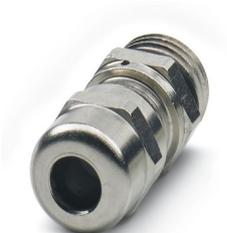
Pressacavi, materiale connessione a vite: Ottone, nichelato, applicazione: Standard, diametro esterno cavo 6 mm ... 11 mm, schermatura: no, filettatura: M20 x 1,5, colore: argento, con elemento di compensazione a pressione e O-ring
