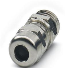
Pressacavi, materiale connessione a vite: Ottone, nichelato, applicazione: Standard, diametro esterno cavo 4 mm ... 7 mm, schermatura: no, filettatura: M12 x 1,5, colore: argento, con elemento di compensazione a pressione e O-ring
