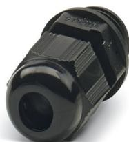
Pressacavi, materiale connessione a vite: PA, applicazione: Standard, diametro esterno cavo 4 mm ... 7 mm, schermatura: no, filettatura: M12 x 1,5, colore: nero intenso RAL 9005, con elemento di compensazione della pressione e guarnizione piatta
