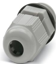
Pressacavi, materiale connessione a vite: PA, applicazione: Standard, diametro esterno cavo 4 mm ... 7 mm, schermatura: no, filettatura: M12 x 1,5, colore: grigio luce RAL 7035, con elemento di compensazione della pressione e guarnizione piatta
