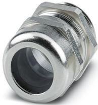
Pressacavi, materiale connessione a vite: Ottone, nichelato, applicazione: Standard, diametro esterno cavo 13 mm ... 18 mm, schermatura: no, filettatura: M32 x 1,5, colore: argento, con O-ring
