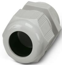
Pressacavi, materiale connessione a vite: PA, applicazione: Standard, diametro esterno cavo 18 mm ... 25 mm, schermatura: no, filettatura: Pg29, colore: grigio luce RAL 7035
