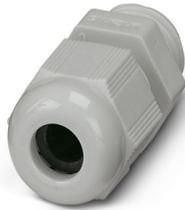
Pressacavi, materiale connessione a vite: PA, applicazione: Standard, diametro esterno cavo 3 mm ... 6,5 mm, schermatura: no, filettatura: Pg7, colore: grigio luce RAL 7035
