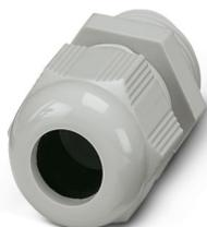
Pressacavi, materiale connessione a vite: PA, applicazione: Standard, diametro esterno cavo 10 mm ... 14 mm, schermatura: no, filettatura: M20 x 1,5, colore: grigio luce RAL 7035
