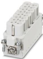
Inserto contatti, numero poli: 16+PE, dimensioni: D25, numero di connessioni per polo: 1, Femmina, Connessione Push-in, 250 V, 16 A, 0,14 mm<sup>2</sup> ... 2,5 mm<sup>2</sup>
