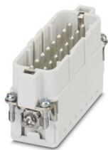
Inserto contatti, numero poli: 16+PE, dimensioni: D25, numero di connessioni per polo: 1, Spina, Connessione Push-in, 250 V, 16 A, 0,14 mm<sup>2</sup> ... 2,5 mm<sup>2</sup>
