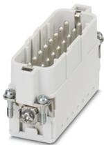
Insero contatti, numero poli: 16+PE, dimensioni: D25, numero di connessioni per polo: 1, Spina, Connessione Push-in, 250 V, 16 A, 0,14 mm<sup>2</sup> ... 2,5 mm<sup>2</sup>
