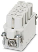
Inserto contatti, numero poli: 10+PE, dimensioni: D15, numero di connessioni per polo: 1, Femmina, Connessione Push-in, 250 V, 16 A, 0,14 mm<sup>2</sup> ... 2,5 mm<sup>2</sup>
