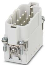
Inserto contatti, numero poli: 10+PE, dimensioni: D15, numero di connessioni per polo: 1, Spina, Connessione Push-in, 250 V, 16 A, 0,14 mm<sup>2</sup> ... 2,5 mm<sup>2</sup>
