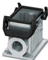
Custodia a zoccolo D50, con blocc. trasversale, materiale: Pressofuso di alluminio, impermeabile, uscite cavi: 2, laterali, 2x Pg29, altezza: 82 mm, connessione a vite per cavo: Pg29, Standard
