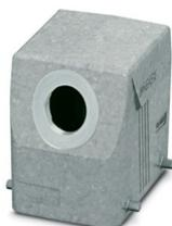
Custodia protettiva D50, per bloccaggio trasversale, materiale: Pressofuso di alluminio, impermeabile, uscite cavi: 1, laterali, 1x Pg21, altezza: 80 mm, connessione a vite per cavo: Pg21, Standard
