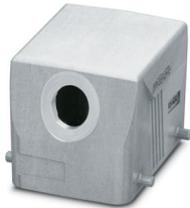
Custodia protettiva D50, per bloccaggio trasversale, materiale: Pressofuso di alluminio, impermeabile, uscite cavi: 1, laterali, 1x Pg21, altezza: 60 mm, connessione a vite per cavo: Pg21, Standard
