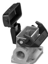
Custodia a zoccolo D15, con blocc. longitudinale, materiale: Pressofuso di alluminio, impermeabile, materiale coperchio: PC, uscite cavi: 2, laterali, 2x M25, altezza: 52 mm, connessione a vite per cavo: senza, coperchio di protezione: sì, Standard
