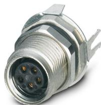
Connettore per apparecchi posteriore, 5-poli, Femmina, diritto, M8, codifica: B, Montaggio posteriore, M10, Saldatura a onde
