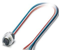
Connettore per apparecchi anteriore, DeviceNet™, 5-poli, Femmina, diritto, M8, Montaggio anteriore, M10, Fili singoli, lunghezza cavo: 0,5 m, 0,25 mm<sup>2</sup>, filo in PVC
