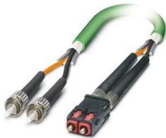
Cavo in fibra ottica confezionato, cavo PROFINET tipo B, fibra PCF 200/230  $\mu\text{m}$ , SC-RJ/IP20 su BFOC(ST)/IP20, guaina esterna in PVC, privo di alogenati, resistente ai raggi UV e all'ozono, per la posa fissa all'interno, lunghezza 0,8 m
