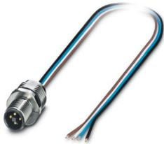
Connettore per apparecchi anteriore, Potenza, 4-poli, Connettore, diritto, M12-Standard, codifica: T, su estremità conduttore libera, Montaggio anteriore, M16 x 1,5, Fili singoli, lunghezza cavo: 0,5 m, 1,31 mm<sup>2</sup>, Filo per l'elettronica UL/cUL, saldato, Prodotto alternativo secondo RoHS II senza eccezione 6c (Pb < 0,1 %) cod. art.: 1239446
