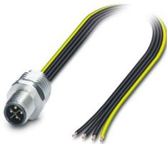
Connettore per apparecchi anteriore, Potenza, 4-poli, Connettore, diritto, M12-Standard, codifica: S, su estremità conduttore libera, Montaggio anteriore, M16 x 1,5, Fili singoli, lunghezza cavo: 0,5 m, 1,31 mm<sup>2</sup>, Filo per l'elettronica UL/cUL, saldato, Prodotto alternativo secondo RoHS II senza eccezione 6c (Pb < 0,1 %) cod. art.: 1239445
