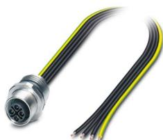
Connettore per apparecchi anteriore, Potenza, 4-poli, Femmina, diritto, M12-Standard, codifica: S, su estremità conduttore libera, Montaggio anteriore, M16 x 1,5, Fili singoli, lunghezza cavo: 0,5 m, 1,31 mm<sup>2</sup>, Filo per l'elettronica UL/cUL, saldato, Prodotto alternativo secondo RoHS II senza eccezione 6c (Pb < 0,1 %) cod. art.: 1239443
