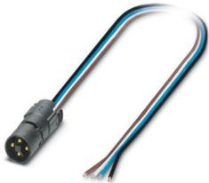
Portacontatti, Potenza, 4-poli, Connettore, diritto, M12-SPEEDCON, codifica: T, su estremità conduttore libera, Montaggio anteriore/flangia quadrata, M12, Fili singoli, lunghezza cavo: 0,5 m, 1,31 mm<sup>2</sup>, Filo per l'elettronica UL/cUL
