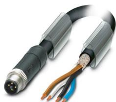
Cavo di alimentazione, 4-poli, PUR senza alogenati, nero RAL 9005, schermata (Advanced Shielding Technology), Maschio diritto M12, codifica: T, su estremità conduttore libera, lunghezza cavo: 1,5 m, per corrente continua fino a 12 A / 63 V
