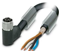
Cavo di alimentazione, 4-poli, PUR senza alogenati, nero RAL 9005, schermata (Advanced Shielding Technology), estremità conduttore libera, su Connettore femmina angolato M12, codifica: T, lunghezza cavo: 3 m, per corrente continua fino a 12 A / 63 V
