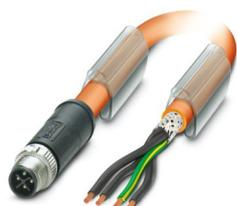
Cavo di alimentazione, 4-poli, PUR senza alogenati, arancio RAL 2003, schermata (Advanced Shielding Technology), Maschio diritto M12, codifica: S, su estremità conduttore libera, lunghezza cavo: 1,5 m, per corrente alternata fino a 12 A/690 V
