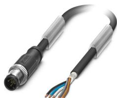
Cavo sensore/attuatore, 5-poli, PUR senza alogenati, grigio-nero RAL 7021, schermata (Advanced Shielding Technology), Maschio diritto M12, codifica: A, su estremità conduttore libera, lunghezza cavo: 30 m
