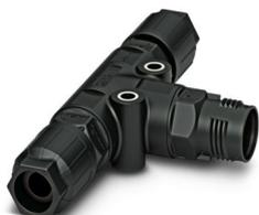
Distributore a T, product family: QPD, tipo di connessione: Connessione IDC, numero poli: 3+PE, 1 mm<sup>2</sup> ... 2,5 mm<sup>2</sup>, 690 V, 20 A, PA, nero, con due dadi QUICKON, codifica: Profilo di codifica, diametro esterno conduttore: 6 mm ... 10 mm
