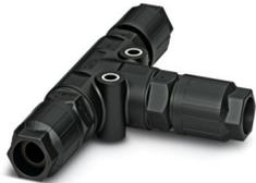
Distributore a T, product family: QPD, tipo di connessione: Connessione IDC, numero poli: 3+PE, 1 mm<sup>2</sup> ... 2,5 mm<sup>2</sup>, 690 V, 20 A, PA, nero, con 3 dadi QUICKON, codifica: Profilo di codifica, diametro esterno conduttore: 9 mm ... 14 mm
