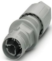
Connettori per cavi, product family: QPD, tipo di connessione: Connessione IDC, 1 mm<sup>2</sup> ... 2,5 mm<sup>2</sup>, 690 V, 20 A, PA, grigio, con un dado QUICKON, codifica: Profilo di codifica, diametro esterno conduttore: 9 mm ... 14 mm
