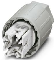
Dado, product family: QPD, tipo di connessione: Connessione IDC, 1 mm<sup>2</sup> ... 2,5 mm<sup>2</sup>, 690 V, 20 A, PA, grigio, diametro esterno conduttore: 9 mm ... 14 mm
