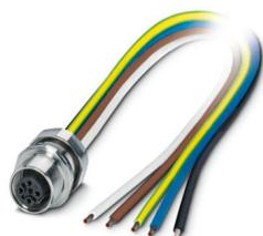
Connettore per apparecchi anteriore, Universale, 5-poli, Femmina, diritto, M12, codifica: B, su estremità conduttore libera, Montaggio anteriore, Pg9, Fili singoli, lunghezza cavo: 0,5 m, 0,34 mm<sup>2</sup>, Filo in TPE, saldato
