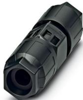
Connettori per cavi, product family: QPD, tipo di connessione: Connessione IDC, numero poli: 3+PE, 1 mm<sup>2</sup> ... 2,5 mm<sup>2</sup>, 690 V, 20 A, PA, nero, con due dadi QUICKON, codifica: Profilo di codifica, diametro esterno conduttore: 9 mm ... 14 mm
