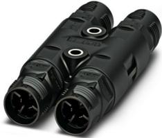
Distributore a H, product family: QPD, tipo di connessione: Connessione IDC/ Attacco rapido QUICKON, numero poli: 3+PE, 1 mm<sup>2</sup> ... 2,5 mm<sup>2</sup>, 690 V, 20 A, PA, nero, senza dado QUICKON, codifica: Profilo di codifica
