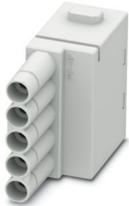
Modulo portacontatti, numero poli: 5, contatti di potenza: 5, contatti di comando: 0, numero di connessioni per polo: 2, Femmina, Connessione Push-in, 230 V/400 V, 16 A, 0,25 mm<sup>2</sup> ... 1,5 mm<sup>2</sup>, applicazione: Potenza
