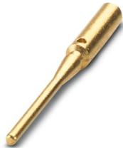
Contatto a crimpare, diametro contatti: 0,6 mm, tornito, Spina, materiale contatti: CuZn, superficie contatti: Ni/Au, sezione di connessione: 0,14 mm<sup>2</sup> ... 0,34 mm<sup>2</sup>, AWG 26 ... 22
