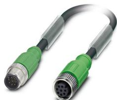
Cavo sensore/attuatore, 8 poli, PVC, nero RAL 9005, schermato, connettore maschio diritto M12, codifica A, su connettore femmina diritto M12, codifica A, lungh.: 10 m, con ghiera VA
