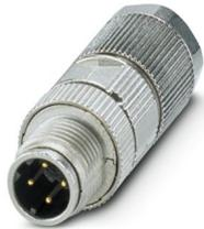
Connettore dati, PROFINET CAT5 (100 MBit/s), 4-poli, schermata, Maschio diritto M12, codifica: D, Connessione a crimpare, materiale zigrinato: Pressofuso di zinco, stagnato, diametro esterno conduttore 4,5 mm ... 7,5 mm, senza contatti a crimpare
