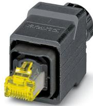
Connettore RJ45, grado di protezione: IP65/IP67, numero poli: 8, 10 Gbit/s, CAT6<sub>A</sub>, materiale: Plastica, tipo di connessione: Connessione a crimpare, sezione di connessione: AWG 27- 24, uscita cavo: diritto, colore: nero, Ethernet
