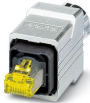
Connettore RJ45, grado di protezione: IP65/IP67, numero poli: 8, CAT6<sub>A</sub>, materiale: Metallo, tipo di connessione: Connessione a crimpare, sezione di connessione: AWG 27- 24, uscita cavo: dritto, colore: argento, Ethernet
