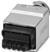
Connettore Power, grado di protezione: IP65/IP67, numero poli: 5, materiale: Metallo, tipo di connessione: Connessione a molla, sezione di connessione: AWG 18- 13, uscita cavo: diritto, Universale
