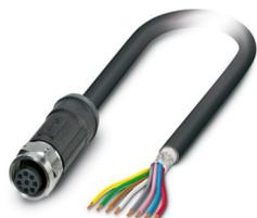
Cavo sensore/attuatore, 8-poli, PE-X/PE-X senza alogenati, grigio-nero RAL 7021, schermata, estremità conduttore libera, su Connettore femmina diritto M12, codifica: A, lunghezza cavo: 15 m, per applicazioni outdoor, con zigrinatura in acciaio inox
