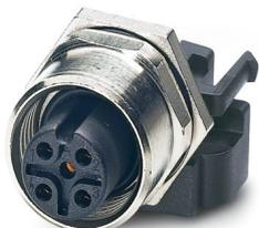
Connettore femmina da incasso sensore-attuatore, 5 poli, M12, codifica A, montaggio posteriore/a vite con filettatura M12, con protezione contro la torsione, attacco a saldare diritto
