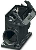
Custodia a zoccolo B24, con blocc. longitudinale, materiale: PA 6.6-FR, uscite cavi: 2, laterali, 2x M25, altezza: 84 mm, connessione a vite per cavo: senza, Standard, inclusi 2 adattatori di riduzione
